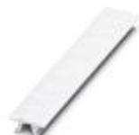
Планка Zack, Полоса, белый, с маркировкой, маркируется с помощью: Плоттер, надписи вдоль: нумерация по порядку 1-10, 11-20 и т.д. до 491-500, Тип монтажа: Крепление в высоких пазах для табличек, для клемм шириной: 6,2 мм, Размер маркировочного поля: 6,15 x 10,5 мм
