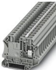
Клеммы с ножевыми размыкателями, с пусковой пластинкой, белым разделительным ножом и винтами для крепления контрольного штекера, Тип подключения: Винтовые зажимы, Сечение: 0,2 мм<sup>2</sup> - 10 мм<sup>2</sup>, AWG: 24 - 8, Номинальный ток: 20 А, Номинальное напряжение: 500 В, Длина: 57,8 мм, Ширина: 8,2 мм, Цвет: серый, Монтаж: NS 35/7,5, NS 35/15
