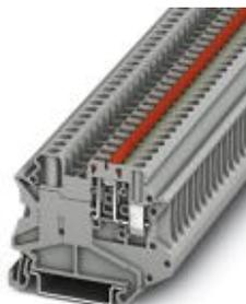
Клеммы с ножевыми размыкателями, с пусковой пластинкой и винтами для крепления контрольного штекера, Тип подключения: Винтовые зажимы, Сечение: 0,14 мм<sup>2</sup> - 6 мм<sup>2</sup>, AWG: 26 - 10, Номинальный ток: 20 А, Номинальное напряжение: 500 В, Длина: 57,8 мм, Ширина: 6,2 мм, Цвет: серый, Монтаж: NS 35/7,5, NS 35/15
