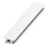
Маркировка для клеммных модулей, Полоса, белый, с маркировкой, маркируется с помощью: Плоттер, горизонтально: L1, L2, L3, N, PE, L1, L2, L3, N, PE, Тип монтажа: Крепление в высоких пазах для табличек, для клемм шириной: 6,2 мм, Размер маркировочного поля: 6,15 x 10,5 мм
