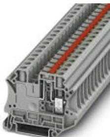
Клеммы с ножевыми размыкателями, с пусковой пластинкой и винтами для крепления контрольного штекера, Тип подключения: Винтовые зажимы, Сечение: 0,2 мм<sup>2</sup> - 10 мм<sup>2</sup>, AWG: 24 - 8, Номинальный ток: 20 А, Номинальное напряжение: 500 В, Длина: 57,8 мм, Ширина: 8,2 мм, Цвет: серый, Монтаж: NS 35/7,5, NS 35/15
