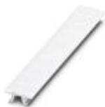
Планка Zack, Полоса, белый, с маркировкой, маркируется с помощью: Плоттер, надписи вдоль: одинаковые номера 1 или 2 и т.д. до 100, Тип монтажа: Крепление в высоких пазах для табличек, для клемм шириной: 6,2 мм, Размер маркировочного поля: 6,15 x 10,5 мм
