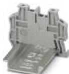
Концевой держатель для быстрого монтажа, для монтажной рейки NS 35/7,5 или NS 35/15, с возможностью нанесения маркировки и установки FBS...5, FBS...6, KSS 5, KSS 6, ширина: 5,15 мм, цвет: серый
