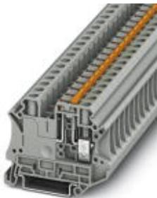
Клеммы с ножевыми размыкателями, с пусковой пластинкой и винтами для крепления контрольного штекера, Тип подключения: Винтовые зажимы, Сечение: 0,2 мм<sup>2</sup> - 10 мм<sup>2</sup>, AWG: 24 - 8, Номинальный ток: 20 А, Номинальное напряжение: 500 В, Длина: 57,8 мм, Ширина: 8,2 мм, Цвет: серый, Монтаж: NS 35/7,5, NS 35/15
