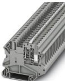
Клеммы с ножевыми размыкателями, с пусковой пластинкой, белым разделительным ножом и винтами для крепления контрольного штекера, Тип подключения: Винтовые зажимы, Сечение: 0,14 мм<sup>2</sup> - 6 мм<sup>2</sup>, AWG: 26 - 10, Номинальный ток: 20 А, Номинальное напряжение: 500 В, Длина: 57,8 мм, Ширина: 6,2 мм, Цвет: серый, Монтаж: NS 35/7,5, NS 35/15
