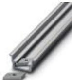
Несущая рейка, глубокотянутая, высокое исполнение, без перфорации, толщина 1,5 мм, материал: алюминий, высота 15 мм, ширина 35 мм, длина 2000 мм
