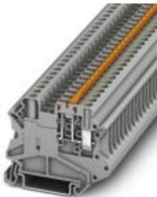
Клеммы с ножевыми размыкателями, с пусковой пластинкой и винтами для крепления контрольного штекера, Тип подключения: Винтовые зажимы, Сечение: 0,14 мм<sup>2</sup> - 6 мм<sup>2</sup>, AWG: 26 - 10, Номинальный ток: 20 А, Номинальное напряжение: 500 В, Длина: 57,8 мм, Ширина: 6,2 мм, Цвет: серый, Монтаж: NS 35/7,5, NS 35/15
